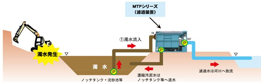
一般的な工事濁水処理では、高分子マイクロフィルターを使用した濾過処理装置（MTPシリーズ）を使用します。機内に溜まった濃縮汚泥水は、ノッチタンク等に送水するか、脱水装置（MTDSシリーズ）により脱水濾過することができます。
