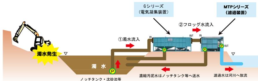
濾過処理装置（MTPシリーズ）の前処理に電気凝集装置（Gシリーズ）を組み込むことで、重金属汚染水への対応が可能です。電気凝集によりフロッグ化した重金属汚染水をフィルター吸引濾過することで、重金属を物理的に除去します。
