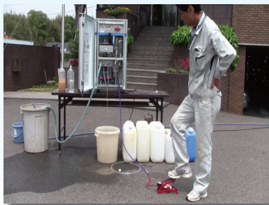
フットポンプによる逆洗状況 ※写真内のトランクケースはオプションです。
