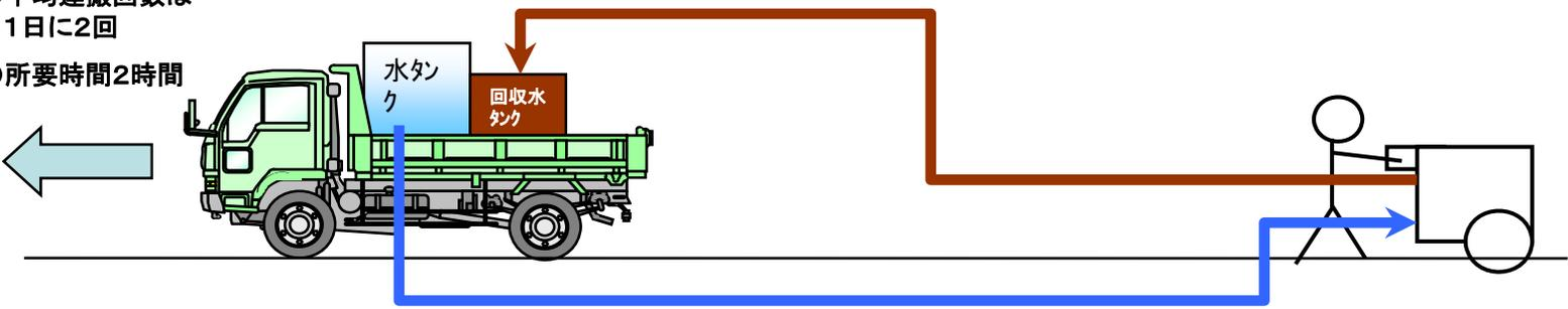
切断水循環脱水濾過システム
